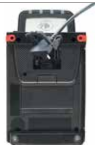
裏面 (専用ケーブル付属) 上位 POS との接続は USB・RS232 から選択いただけます。
